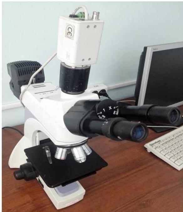
Рисунок 1 – Микроскоп лабораторный металлографический
