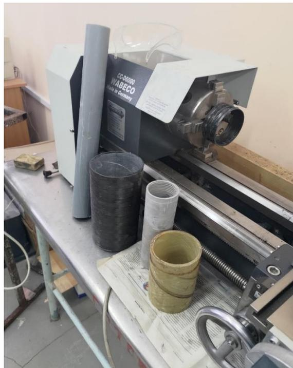
Рис.1 – Токарный станок CC-D6000
